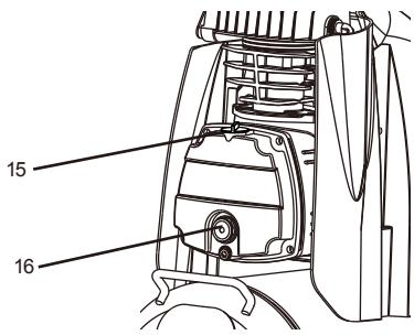
1. Открутите и снимите пластиковую крышку (15).
