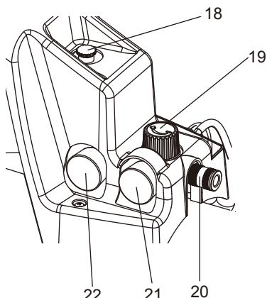
2. Установите регулятор давления (19) на необходимом уровне рабочего давления. Текущее рабочее давление отображается на манометре регулируемого давления (21).
