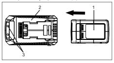
Это диагностическое зарядное устройство. Светодиодные лампы зарядного устройства (3) будут гореть в определенном порядке, чтобы показать текущее состояние аккумулятора. Это происходит следующим образом:
